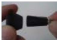
ビデオレンズアタッチメントをスコープ視部に装着します。
