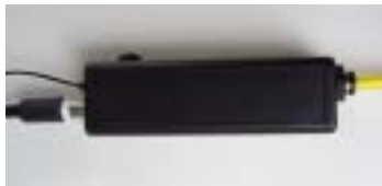
エアブロー使用時には操作BOXにスコープ側チューブとエアホースキットチューブをワンタッチ接続します。
