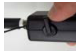
スコープを覗きながらバルブを指で開閉すればスコープ先端部分からエアが出ます。
