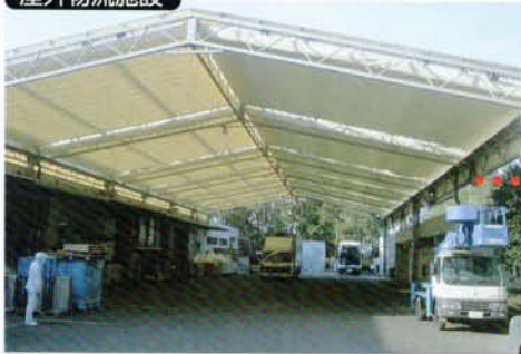
屋外テントを複数枚同時に一台のウインチにて稼動します。また、ワイヤーにテンション装置は必要ありません。(電動GS-200を使用)
